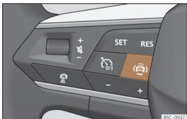
Kuva 120 Monitoimiohjauspyörässä vasemmalla: kuljettajaa avustavien järjestelmien painike (mallista riippuen).
