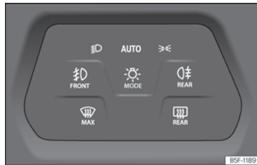
Kuva 99 Kojelauta: valojen käyttöelementti
