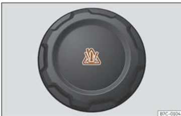
Kuva 217 Etutila: jäähdytysnesteen paisuntasäiliön korkki.
