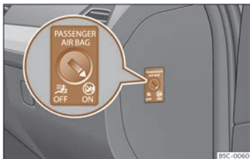
Kuva 29 Avainkytkin, josta etumatkustajan turvavyönn kytketään päälle/pois.
