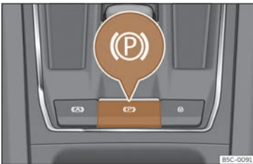
Kuva 145 Keskkikonsolin alaosassa: sähköisen seisontajarrun painike.
