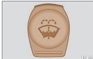
Kuva 219 Moottoritilassa: pesunestesäiliön sininen korkki.
