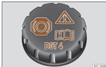
Kuva 218 Moottoritala: jarrunestesäiliön korkki
