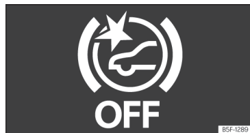
Kuva 136 Mittariston näyttö kertoo, että Front Assist on pois päältä.
