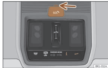
Kuva 50 Kattokonsolissa: puhepalvelujen kytkin.
