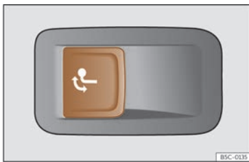
Kuva 195 Tavaratilan vasemmalla sivulla: painike vetokoukun vapauttamiseksi.
