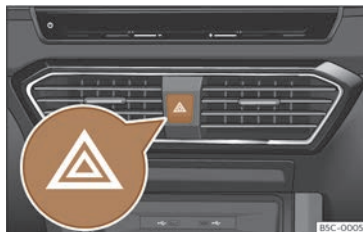
Kuva 49 Kojelautu: varoitusvilkkujen kytkin
