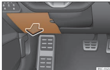
Kuva 210 Kojelaudassa kuljettajan puolella: sulakekotelon kansi.
