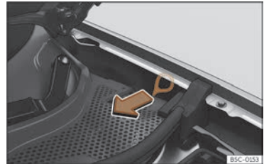
Kuva 59 Vasemman lokasuojan ja konepellin saranan välissä: latauspistokkeen manuaalisen hätävapautuksen vetolenkki.
