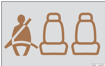
Kuva 20 Mittaristo: takaistuinpaikkojen turvavöiden käyttötila.
