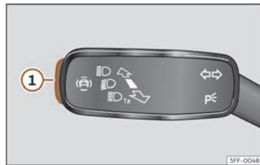
Kuva 119 Viilku- ja kaukovalovivussa: kuljettajaa avustavien järjestelmien painike (mallista riippuen).
