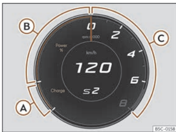
Kuva 7 Digitaalinen mittaristo: powermeter (Cupra-näkymä)
