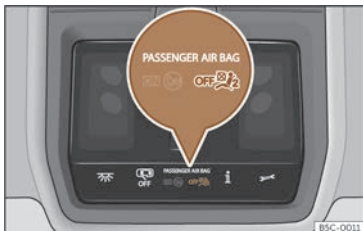
Kuva 30 Kattokonsolissa: poiskytketyn etumatkustajan turvavyönn merkkivalo.
