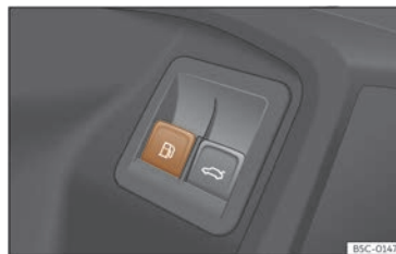
Kuva 200 Kuljettajan ovi: tankkausluukun lukon avaus.
