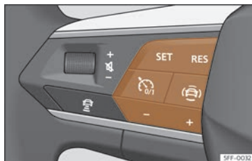
Kuva 127 Monitoimiohjauspyörässä: vakionopeudensäätimen käyttöpainikkeet.
