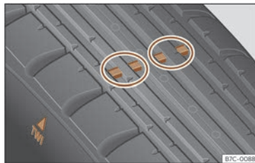
Kuva 228 Renkaan kulutuspiinta: kulumisvaroittimet.
