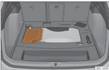
Kuva 224 Lataushybridiautojen (PHEV) akun sijainti tavaratilassa
