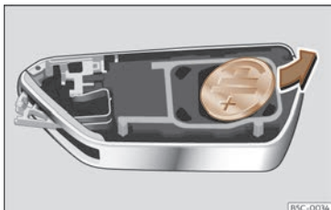
Kuva 67 Autonavain: pariston poistaminen.
