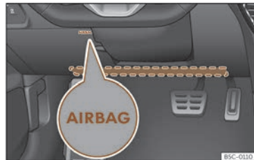
Kuva 36 Kuljettajan polviturvatyynyn sijainti.
