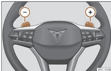
Kuva 116 Ohjauspyörä: automaattivaihteiston vaihteenvaihtimet.
