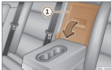
Kuva 190 Takaselkänoja: läpilastausluukun avaus.
