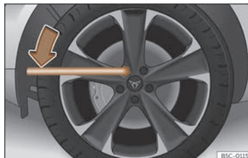
Kuva 234 Pyöränvaihto: pyöränpulttien löysääminen
