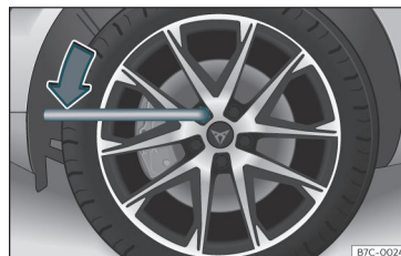
Kuva 41 Pyöränvaihto: pyöränpulttien löysäminen.
