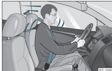
Kuva 10 Turvavyötä oikein käytävä kuljettaja ei sinkoudu eteenpäin äkkijarrutuksessa tai -pysähdyksessä.
