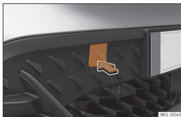
Kuva 149 Etupuskurin oikea puoli: peitekannen irrotus.
