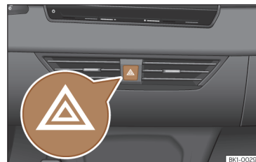
Kuva 40 Kojelauta: varoitusvilkkujen kytkin.
