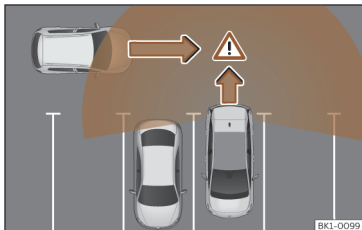
Kuva 115 Kaaviokuva poistumisavustimesta: valvottava alue auton takapuolella.
