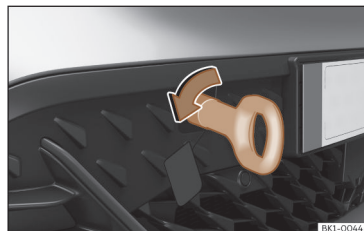
Kuva 150 Etupuskurissa oikealla: kiinnitetty hinaussilmukka.
