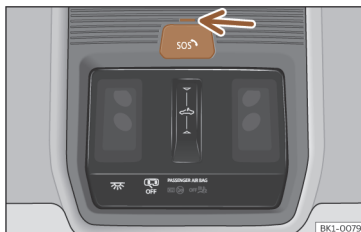
Kuva 41 Kattokonsolissa: puhepalvelujen kytkin
