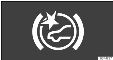
Kuva 107 Mittariston näyttö: ennakkovaroituksen näyttö.
