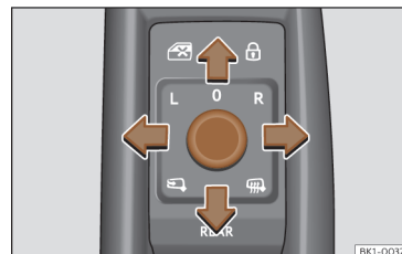
Kuva 88 Kuljettajan ovela: ulkopeilien säätönappi.
